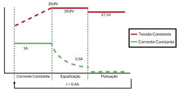
O gráfico acima, apresenta os estágios de carga do carregador de baterias, ilustrando o comportamento da tensão e corrente das baterias bem como o ponto de migração de um estágio para o outro. Vale ressaltar que os valores de corrente podem variar conforme o modelo de fonte.
