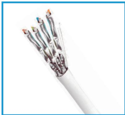
El cable sólido U/FTP SATRA Categoría 6A LSZH, de 4 pares trenzados, combina el desempeño de 10Gbps con seguridad e inmunidad al ruido. Cumple y supera los requerimientos descritos en las especificaciones de la norma ANSI/TIA-568.2-D, brindando un ancho de banda (frecuencia de operación) de 500MHz.
